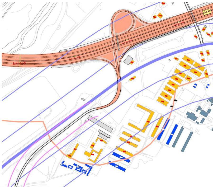
*figura 1 - nuovo svincolo "Lazzaretto" come riportato nel SIA, con estensione delle fasce di pertinenza acustica e chiusura del buffer circolare*
